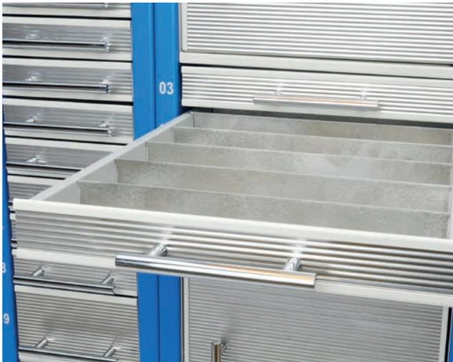
Jede Schublade ist elektromechanisch verriegelt und wird per Software nach erfolgter Verbuchung des zu entnehmenden Artikels entriegelt. Eine Schublade kann als großes Einzelfach für lange Werkzeuge wie z.B. Messwerkzeuge, Montagewerkzeuge, Bohrwerkzeuge etc. genutzt werden.
