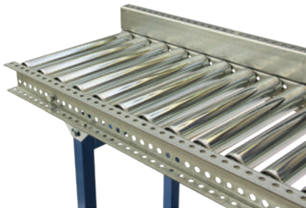
Seitenführungen verzinktes U-Profil 40 / 80 / 40 x 3 mm, Führungshöhe bis 75 mm über Rolle, beidseitig
