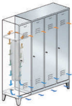
Belüftungs-Konzept Der Luftaustritt im hinteren Schrankboden sorgt für eine gute Belüftung und Trocknung im Abteil. Bei Sockelschränken erfolgt die Entlüftung über Öffnungen oberhalb des zurückgesetzten Sockels.
