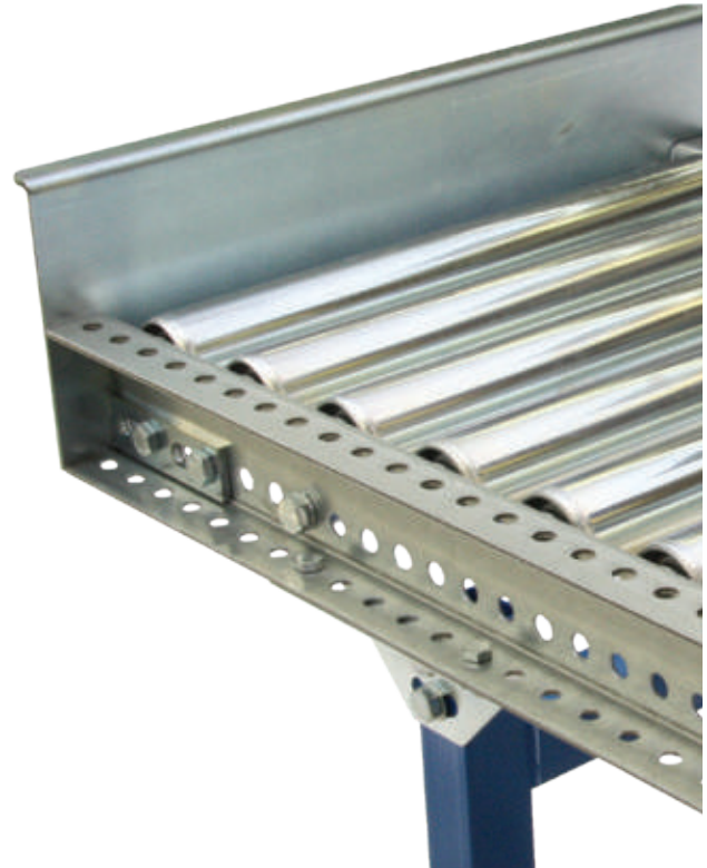
Seitenführungen verzinktes U-Profil 40 / 80 / 40 x 3 mm, Führungshöhe bis 75 mm über Rolle, einseitig
